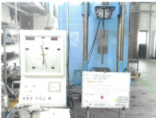
写真 4 WSD490・WD41J SM490A 溶接引張試験 試験体 2
