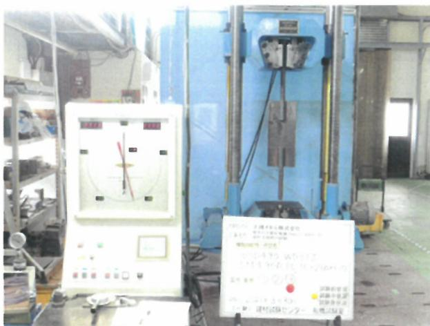
写真 5 WSD490・WD41J SM490A 溶接引張試験 試験体 3
