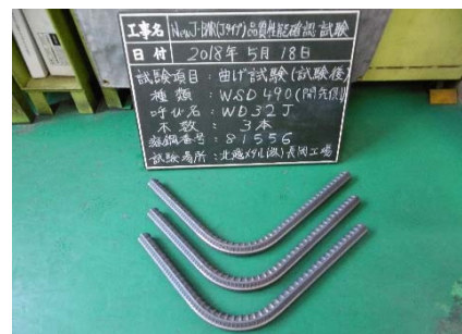
写真1.WD32Jの引張試験後及び曲げ試験後の状況写真
