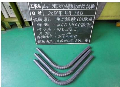
写真1.WD32Jの引張試験後及び曲げ試験後の状況写真
