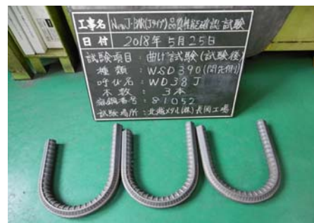
写真1.WD38Jの引張試験後及び曲げ試験後の状況写真
