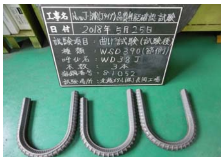
写真1.WD38Jの引張試験後及び曲げ試験後の状況写真
