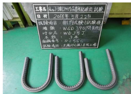
写真1.WD35Jの引張試験後及び曲げ試験後の状況写真
