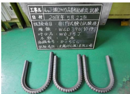
写真1.WD35Jの引張試験後及び曲げ試験後の状況写真
