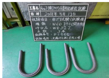
写真1.WD32Jの引張試験後及び曲げ試験後の状況写真
