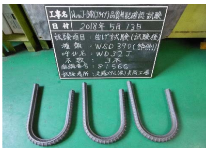
写真1.WD32Jの引張試験後及び曲げ試験後の状況写真
